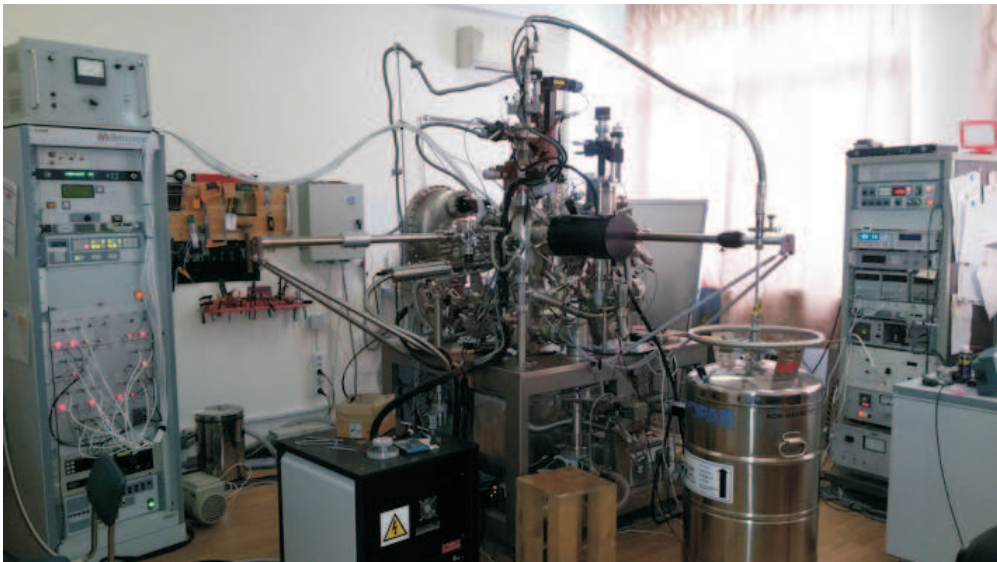
Рис. 2.9. Фотография СВВ установки Omicron STM XA.
