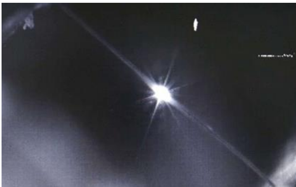
Рисунок 1.3 - Фотография лазерной плазмы, генерируемая на поверхности человеческого волоса (диаметр волоса 60 мкм).
